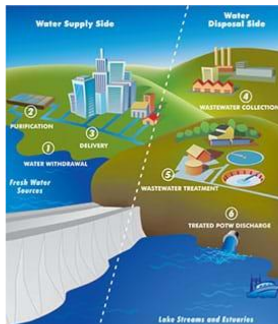
Фигура 1. В градския воден цикъл водата се почиства и третира, тъй като се извлича от източници на прясна вода и се почиства и третира, преди да бъде върната в източници на прясна вода.
